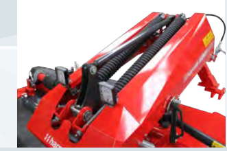
YAY DESTEKLİ YÜZDÜRME SPRING SUPPORTED FLOATING
