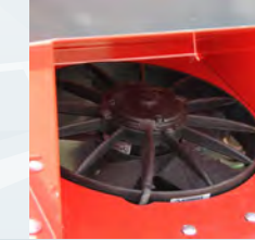
GÜÇLÜ FAN SİSTEMİ KNOTTER GROUP CLEANING FAN
