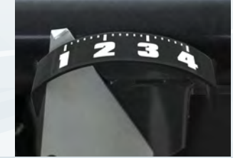
SAP GENİŞLİĞİ AYARI GÖSTERGESİ STEM WIDTH ADJUSTMENT INDICATOR
